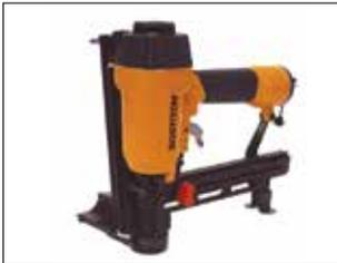
**Deckkappen-Hefter** (Bostitch Typ SL1838BC-E) pneumatisch zur Befestigung von Wellpappe und Karton an Holz, Befestigung von Folien und Plakaten. Die Deckkappe verhindert das unerwünschte Durchschliessen der Klammern in weichen Materialien wie Wellpappe und ähnliche.
