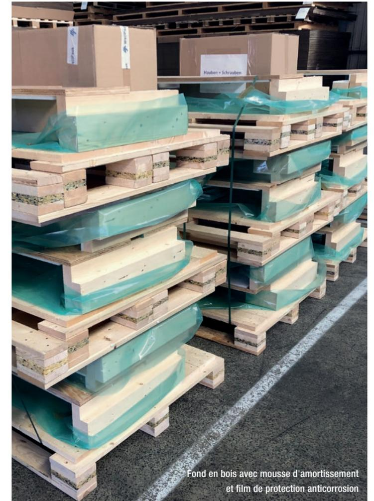
Fond en bois avec mousse d'amortissement et film de protection anticorrosion
