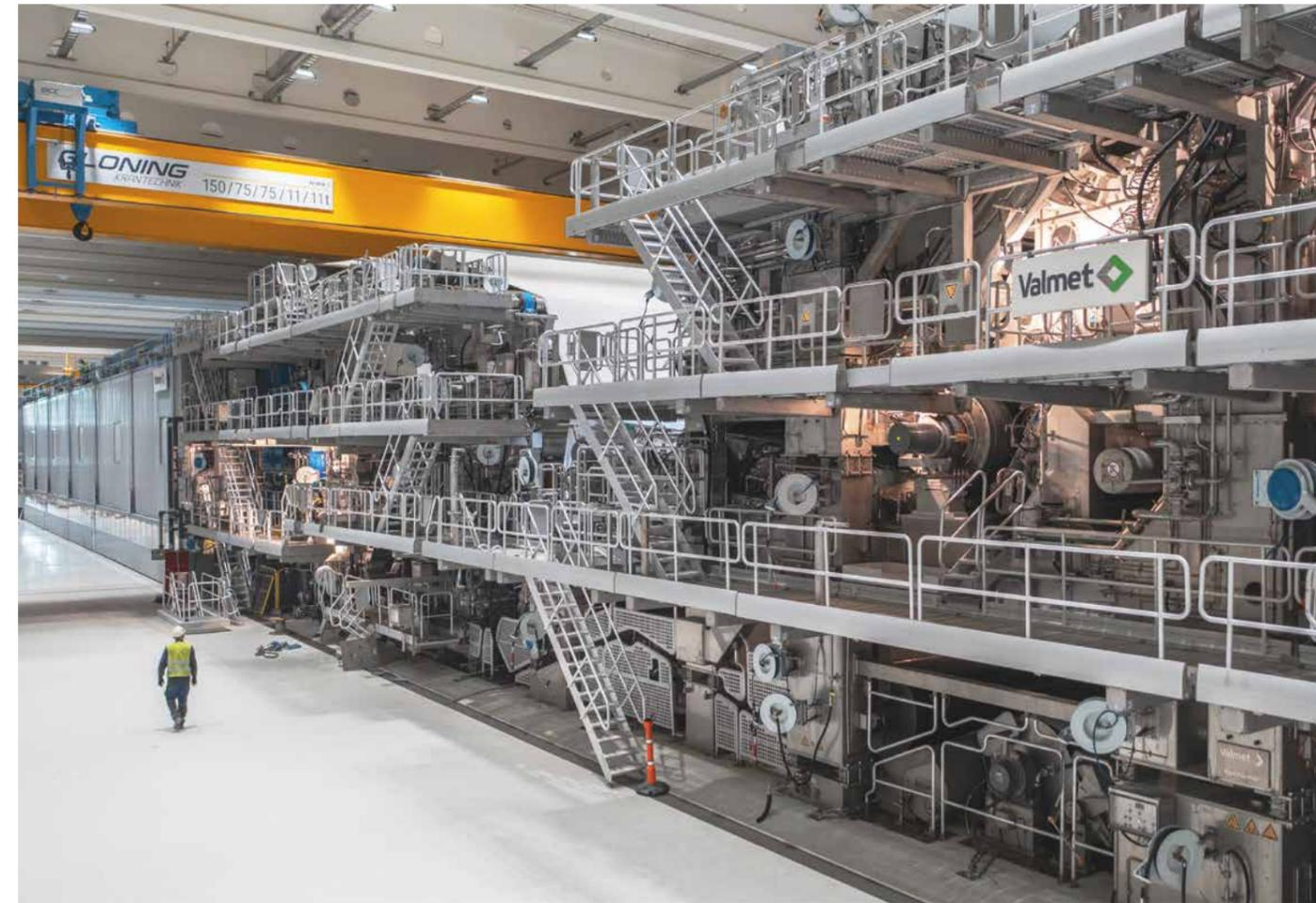
Die neue PM 5 im Werk Aalen mit einer Arbeitsbreite von 10,90 m ist spezialisiert auf die Produktion von leichtgewichtigen Wellpappenrohropapieren.
