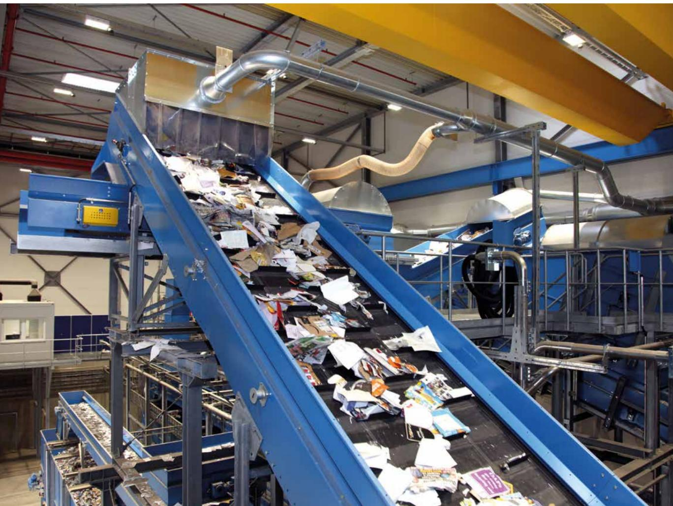
Auch bei Palm Paper in King's Lynn basiert die Produktion von grafischen Papieren vollständig auf ausgesuchten und sortierten Recycling-Faserstoffen. Seit 2019 ist eine eigene Sortieranlage für Haushaltssammelware auf dem Werksgelände in Betrieb.
