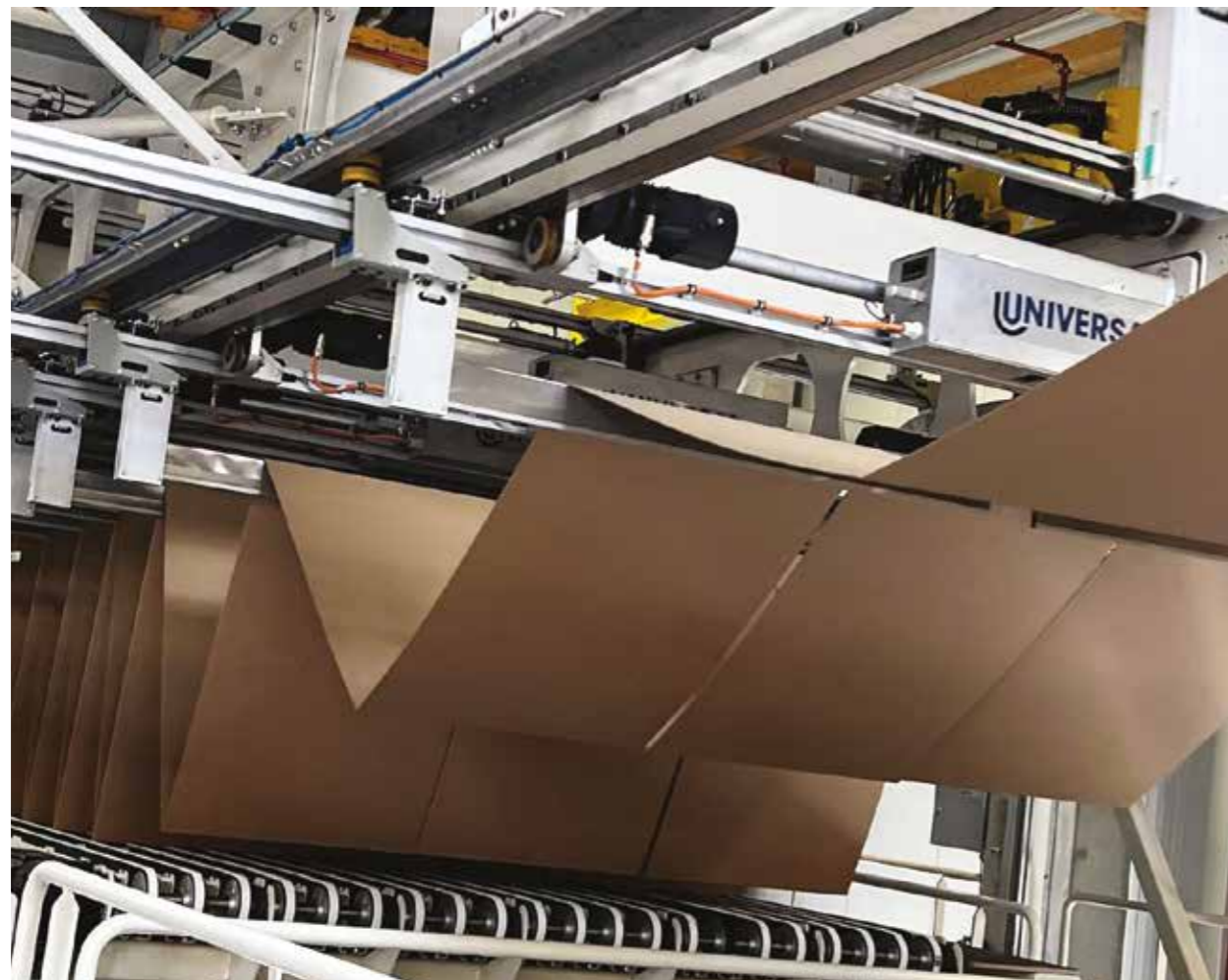
Produktion von Endloswellpappe für passgenaue Verpackungen in unserem Werk Eurowell in Zorbau.
