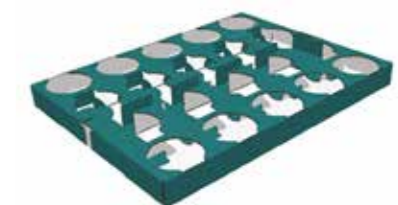
Die „Ökosteige“: Durch eine Konstruktionsänderung von Bechersteigen spart Packwell Schwepnitz Ressourcen und CO 2 ein.
