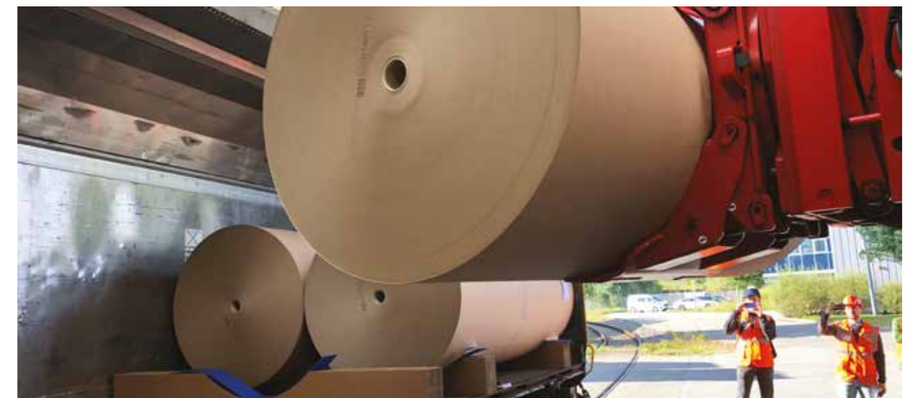
Nachhaltige Ladungssicherung aus Wellpappe für den Transport unserer Papierrollen auf der Schiene.
